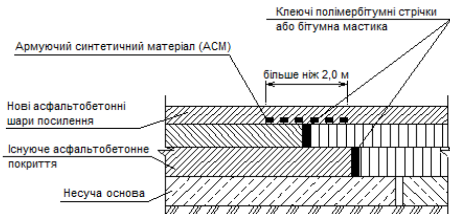
Рисунок 12.14 – Схема поширення конструкцій дорожнього одягу з використанням АСМ (вигляд у поперечному напрямку)
