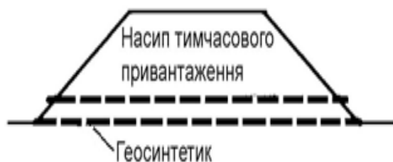
г) між основою і ґрунтом тимчасового привантаження
