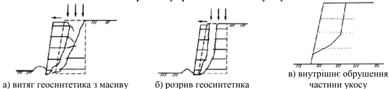
Рисунок 7.2 – Схеми втрати стійкості укосів
