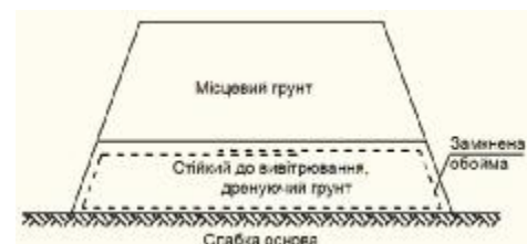
г) одношарове армування насипу замкненою обоймою
